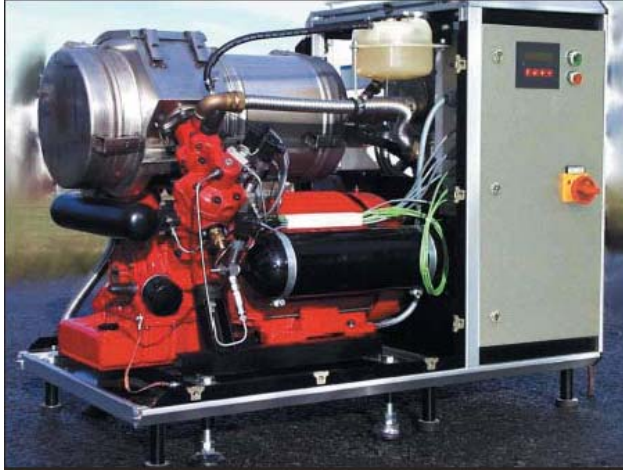
Abbildung 24 2-9 kW el /8-24 kW th Mikro-KWK-Modul Stirling 161 (Quelle: Solo Stirling GmbH /L 36 /) Abmessungen : Länge 1280 mm, Breite 700 mm, Höhe 980 mm, Gewicht 450 kg
